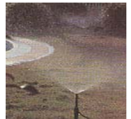
WLST 0602 离心式塑料微喷头 1/2 P=75 ~ 250kpa D=3.0 ~ 9.0m Q=140 ~ 740L/h
